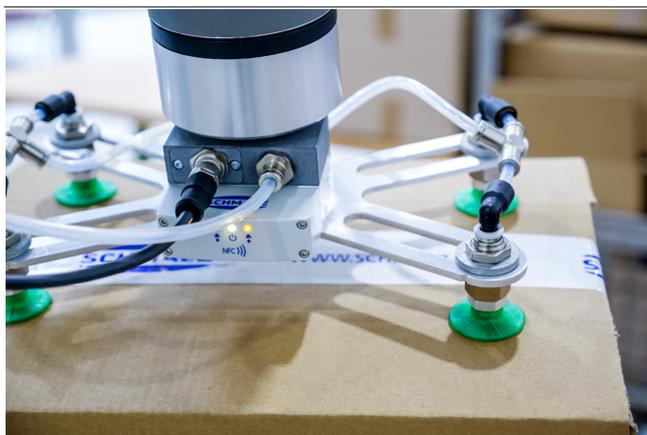
Pneumatischer Vakuum-Erzeuger RECBI bei der Handhabung von Kartonagen
